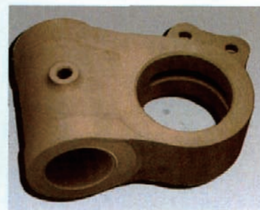
EBM 成形加工过程: 由 CAD 直接快速成形
