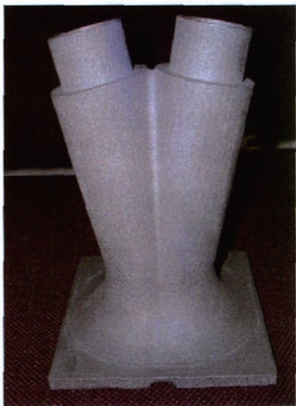
采用 EBM 方法为 NASA 生产的火箭连接尾管
