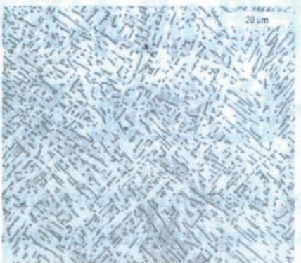
铸造 Ti6Al4V 钛合金
